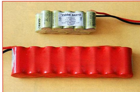
A sinistra due pacchi batterie NiCd: in alto uno con 10 celle da 500mAh, in basso uno con 8 celle da 2400mAh. A destra due pacchi con le recentissime Li-Po: in alto uno con tre celle da 1200mAh, in basso uno da due celle da 700mAh.
